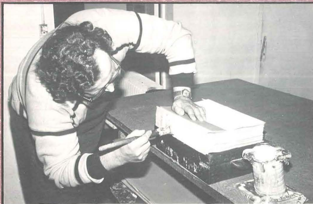
Couseuse électrique Encollage du dos d'un volume
