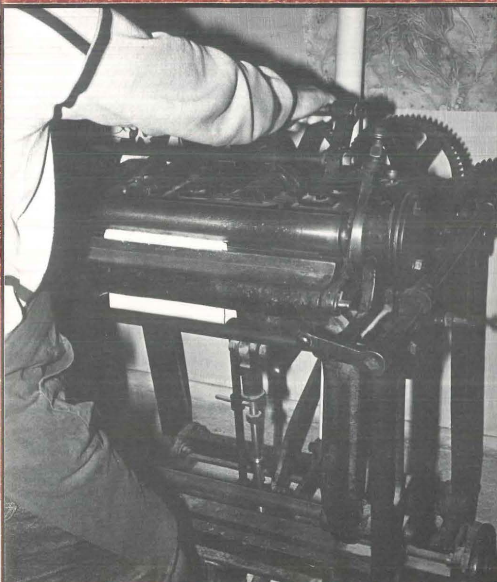
Coupe du livre au massicot Réalisation des mors à la machine à rouleau
