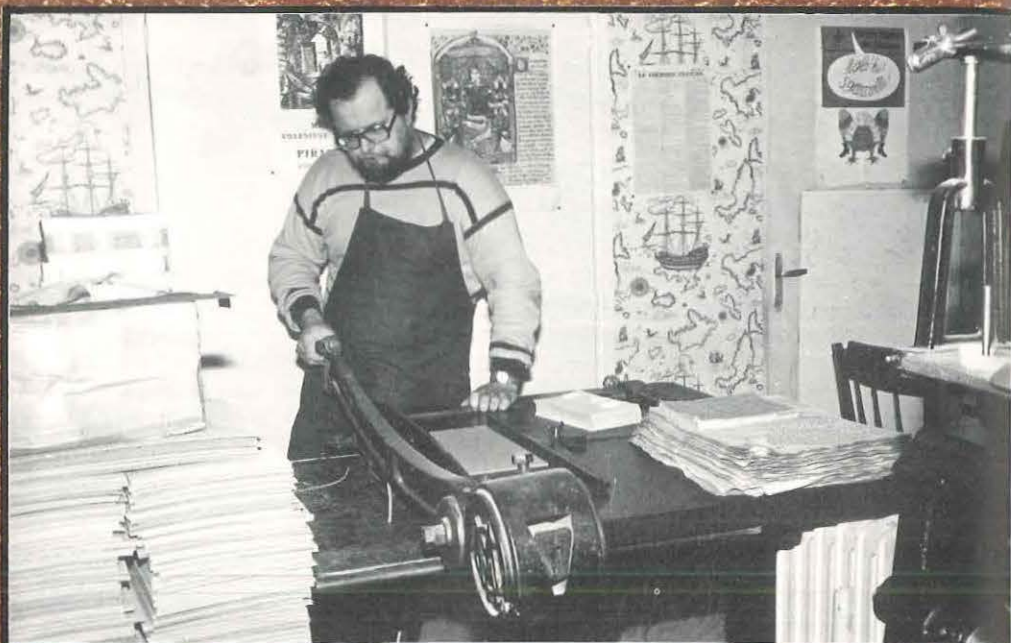
Coupe des cartons à la cisaille Pinçage des nerfs à la pince à nerfs
