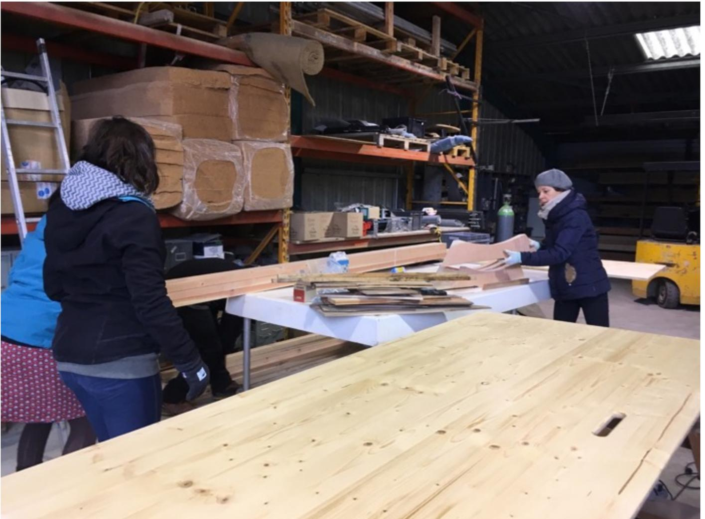
Nécessité de faire un débit avant de commencer : il faut dessiner les pièces dont on va avoir besoin pour la réalisation, en déterminer la taille et réfléchir à comment on va les couper dans le bois que l'on a afin de ne pas gaspiller ou se retrouver avec des pièces trop courtes. Il faut tracer les traits de coupe sur les planches.
