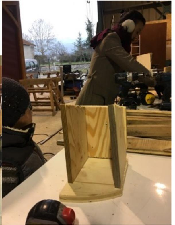
Pour assembler les planches, il faut anticiper l'endroit où on va visser. Si c'est près du bord, il faut que les fibres du bois soient perpendiculaires au bord, sinon, en vissant le bois risque de casser.
