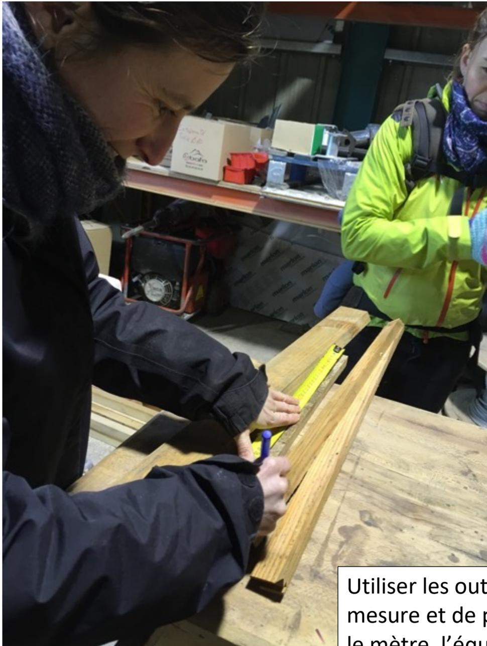
Utiliser les outils de mesure et de précision : le mètre, l'équerre
