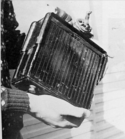
*Un radiateur de chauffage d'une auto*
